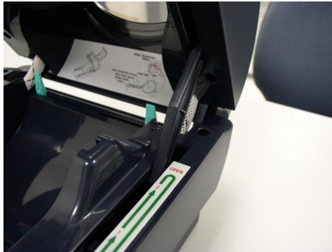
図 2 トップカバーが完全に開かれ、閉じる準備が完了
